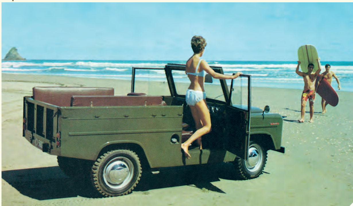
Самый простой вариант Трекка имел открытый кузов без тента, откидной задний борт и продольные лавки в задней части салона.
