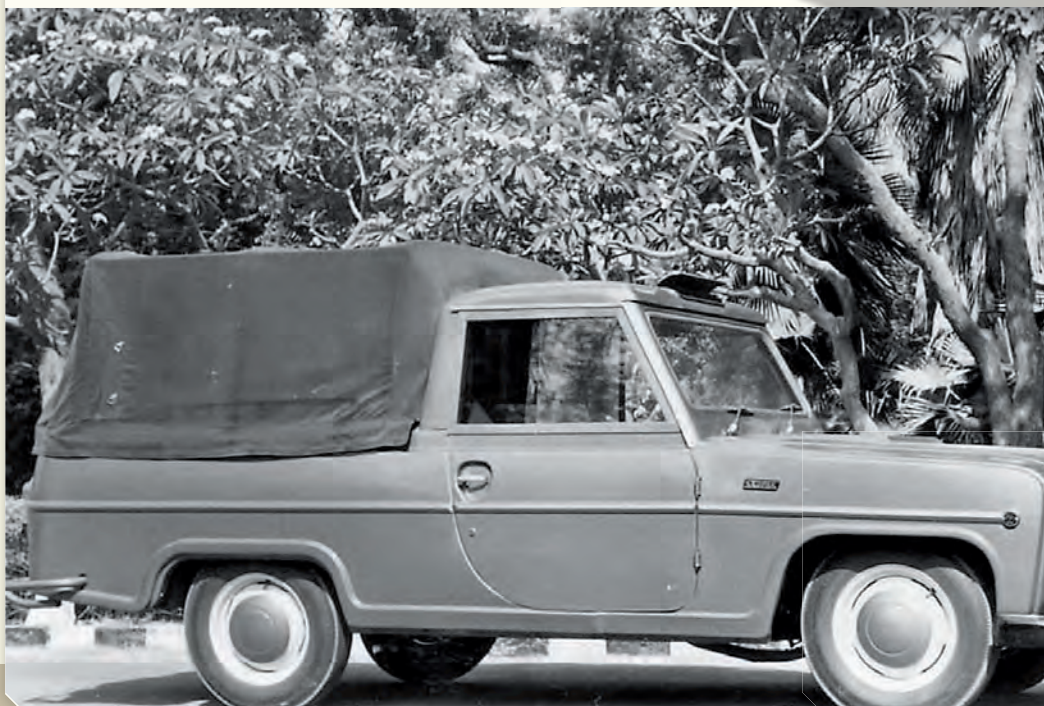
В мае 1970 года в Пакистане началось мелкосерийное производство автомобиля Скорак с кузовом из фибергласса и агрегатами ŠKODA Octavia Combi.
