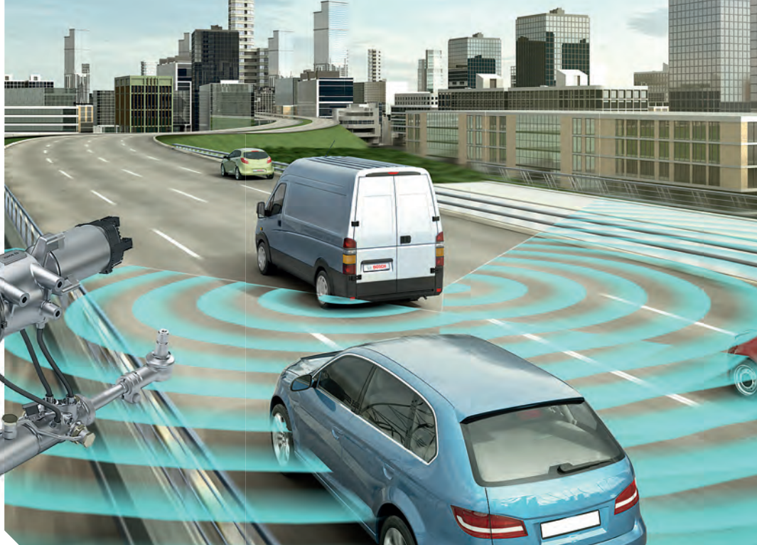
Для распознавания «слепых» зон используются радиолокационные датчики, которые следят за областями рядом с автомобилем, обнаруживают других участников дорожного движения и оповещают о них водителя.
